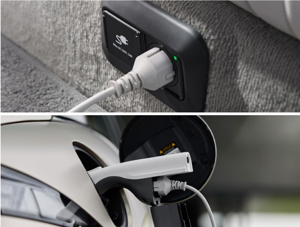
Система розподілу енергії батареї для живлення зовнішніх приладів (V2L)
