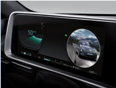
Система відеомоніторингу «сліпих» зон на панелі приладів, BVM
